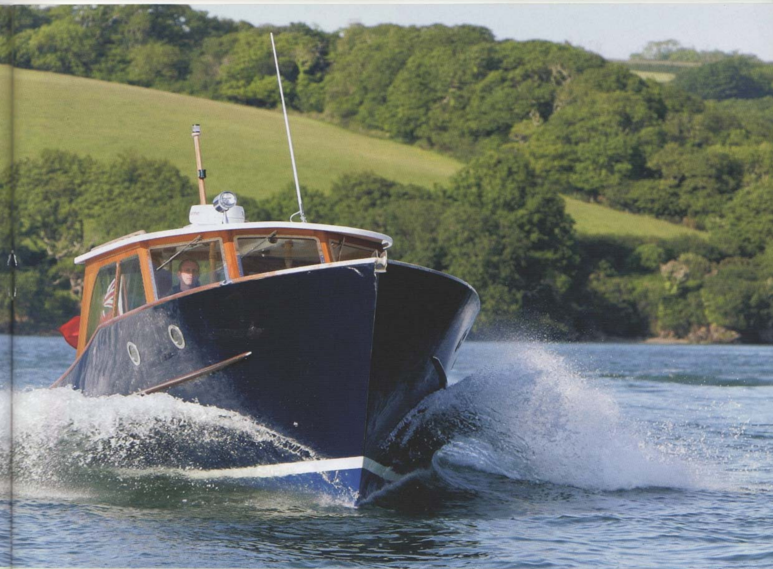
De Cockwells Classic L II T is een halfplanerende massief houten motorboot, met een lengte van bijna tien meter.
