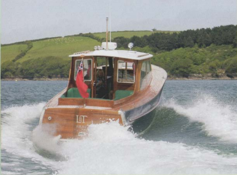
De L II T heeft dankzij de twee motoren en de twee roeren van brons veel grip in de bocht.
