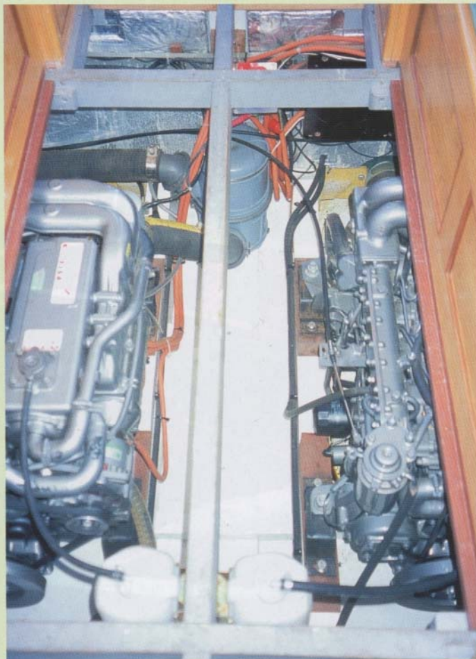
De twee viercilinder Yanmar diesels.
